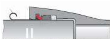
L'assemblage achevé, vérifier sur tout le pourtour la bonne assise du joint TYSP à l'aide de la réglette métallique.
